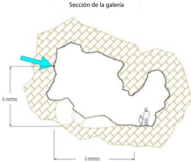
Sección de la galería donde se colocó el dispositivo para realizar el recuento y ubicación del dispositivo cuentapersonas
